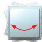
Крепление решетки при монтаже вентилятора предусматривает регулировку угла поворота лицевой панели относительно корпуса, что обеспечивает сглаживание неточностей при монтаже. Лицевая панель может поворачиваться на 10°.
